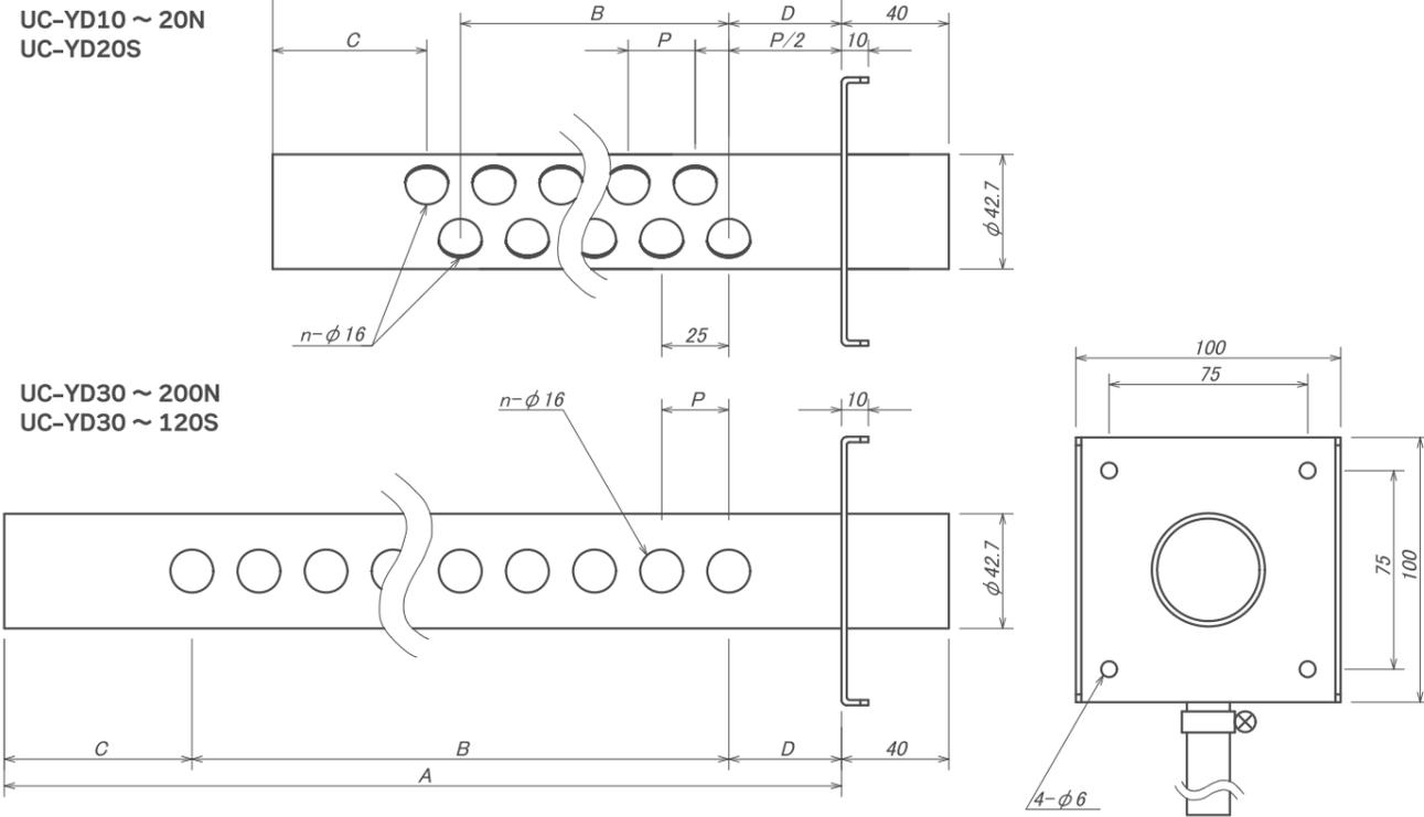
UC-YDN用蒸気ノズル対応表
