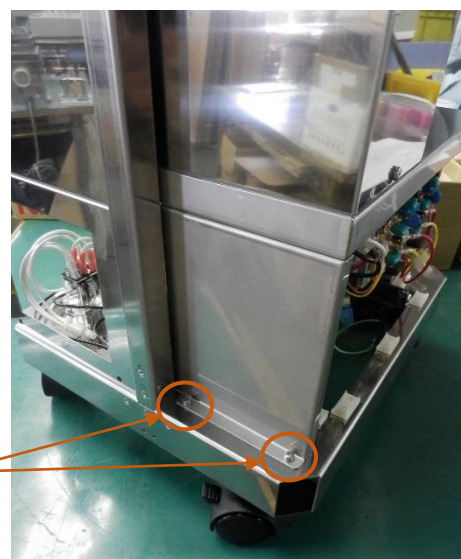
水槽部左下固定ネジ M4×2
